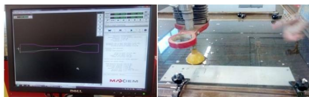
Fig. 1.3. Schița 2D a epruvetei și fixare plăcii de aluminiu pe suportul mașinii
