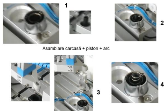
Fig. 3.3 Etapele de asamblare carcasă - piston - arc.
