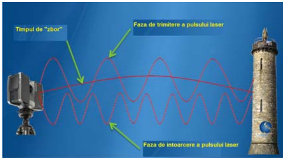
Fig. 2. Principiul scannerului laser 3D „timp-de-zbor”.
