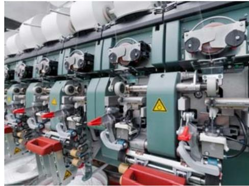
Fig. 7. Rieter J 26 Air-jet spinning machine.
