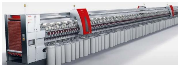
Fig. 20. Schlafhorst rotor spinning machine Autocoro 9.
