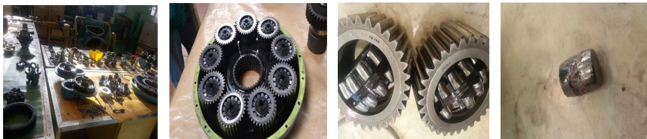
Fig. 7. Imagini cu demontarea cutiei, sateliti si bila sateliti.
