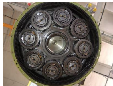
Fig. 9. Portsatelitul cu cei opt sateliți ai etajului al doilea al reductorului, vedere de jos. Foto: AIBN.
