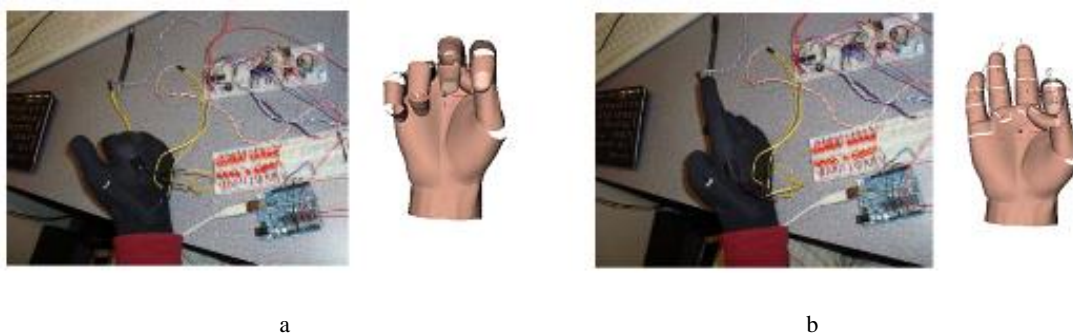
Fig. 8. Interacțiunea cu mediul virtual utilizând mănușa cu senzori de captare a mișcării: mâna strânsă (a), numai doua degete strânse (b).
