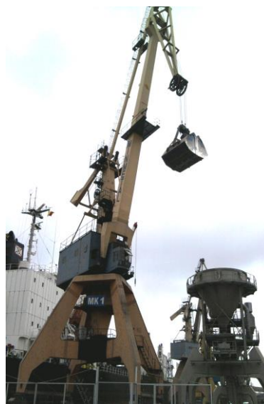
Fig. 1. Macara portuară de chei Bocșa 16 t - 32 m cu graifâr mecanic.
