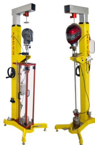
Fig. 3.3. Testul dinamic de retenție
