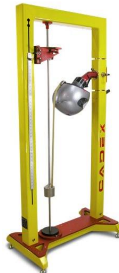
Fig. 3.2. Test de stabilitate pozițională
