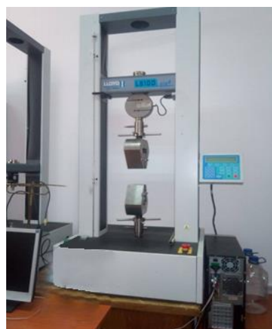
Fig. 1.7. Mașina folosită pentru încercarea la tracțiune LLOYD L5100
