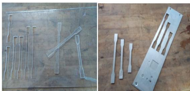
Fig. 1.4. Epruvetele și matrițele rezultate
