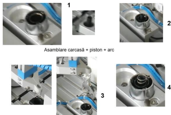
Fig. 3.3 Etapele de asamblare carcasă - piston - arc.
