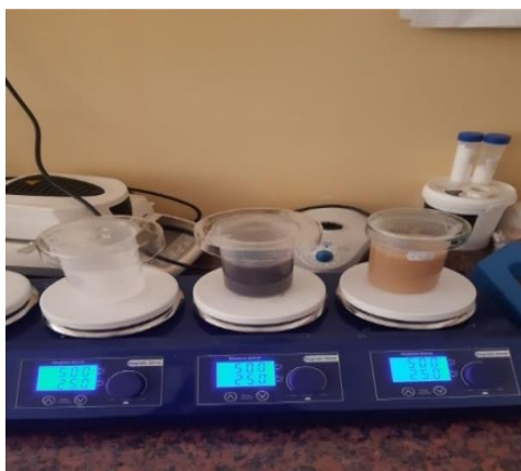
Fig. 5. Agitator magnetic utilizat pentru modificarea suprafeței particulelor de deșeurilor de carbonat de calciu.
