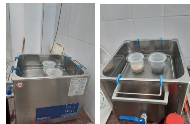
Fig. 6. Baie cu ultrasunete de tip Bandelin utilizată pentru modificarea suprafeței particulelor de deșeurilor de carbonat de calciu
