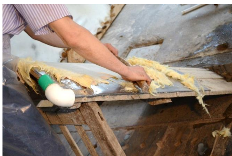
Imaginea 1. Obținerea pergamentului în Atelierul de fabricare a pergamentului, INCDDP-ICPI, București: îndepărtarea părului utilizând un chișlău și un cuțit în formă de semilună cu mânere de lemn; întinderea pergamentului ud pe rama de lemn și tensionarea
