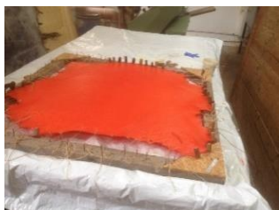
Imaginea 1. Obținerea pergamentului în Atelierul de fabricare a pergamentului, INCDDP-ICPI, București: îndepărtarea părului utilizând un chișlău și un cuțit în formă de semilună cu mânere de lemn; întinderea pergamentului ud pe rama de lemn și tensionarea
