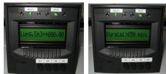
Fig.5.4. Sistem achiziție date instalația de vulcanizare continuă
