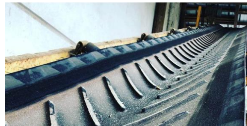
Fig.5.3. Bandă transportoare cu nervuri
