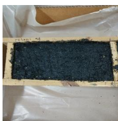
Fig. 2.1. Cărămidă cu știuleți de porumb - rețeta 1
