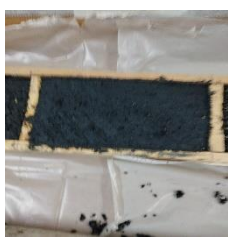
Fig. 2.2. Cărămidă cu știuleți de porumb - rețeta 2
