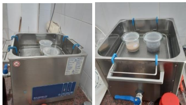
Fig. 6. Baie cu ultrasunete de tip Bandelin utilizată pentru modificarea suprafeței particulelor de deșeurii de carbonat de calciu
