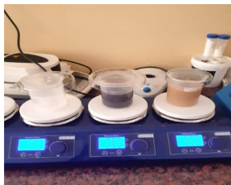
Fig. 5. Agitator magnetic utilizat pentru modificarea suprafeței particulelor de deșeu de carbonat de calciu
