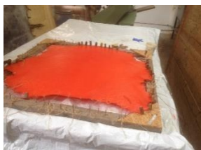
Imaginea 1. Obținerea pergamentului în Atelierul de fabricare a pergamentului, INCDTP-ICPI, București: îndepărtarea părului utilizând un chișlău și un cuțit în formă de semilună cu mânere de lemn; întinderea pergamentului ud pe rama de lemn și tensionarea
