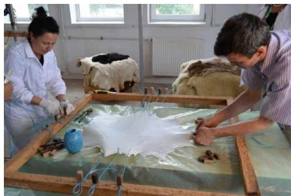
Imaginea 1. Obținerea pergamentului în Atelierul de fabricare a pergamentului, INCDTP-ICPI, București: îndepărtarea părului utilizând un chișlău și un cuțit în formă de semilună cu mânere de lemn; întinderea pergamentului ud pe rama de lemn și tensionarea
