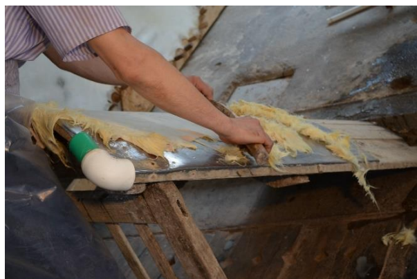
Imaginea 1. Obținerea pergamentului în Atelierul de fabricare a pergamentului, INCDTP-ICPI, București: îndepărtarea părului utilizând un chișlău și un cuțit în formă de semilună cu mânere de lemn; întinderea pergamentului ud pe rama de lemn și tensionarea
