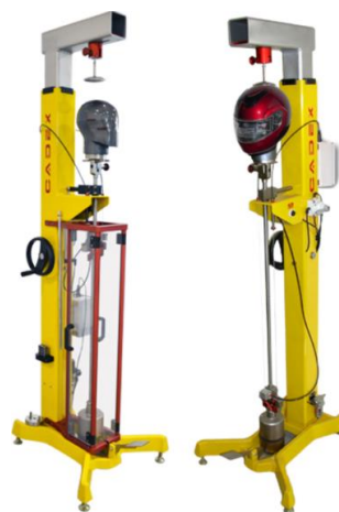
Fig. 3.3. Testul dinamic de retenție
