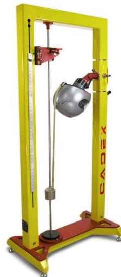
Fig. 3.2. Test de stabilitate pozițională
