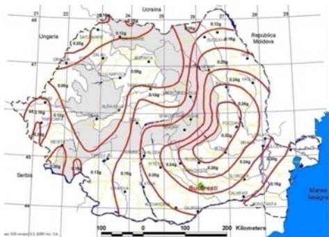
Fig. 6. Zonarea teritoriului României în termeni de valori de vârf ale accelerației terenului pentru proiectare a_g pentru cutremure având intervalul mediu de recurență IMR = 100 ani.
