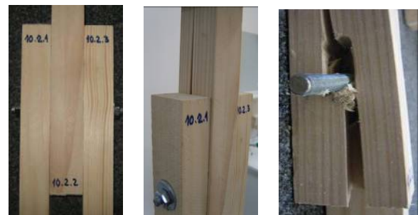
Fig. 5. Îmbinare cu tija Φ 10 mm, după testare [6].
