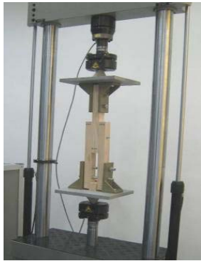
Fig. 2. Îmbinare testată la tracțiune-compresiune [6].
