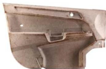
Fig. 5. Panou de portieră din materiale compozite ranforsate cu fibre naturale și rășini polimerice [4].
