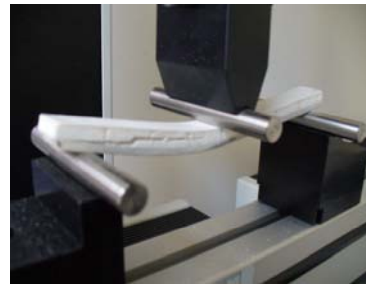
Fig. 4. Ruperea epruvetei în timpul încercării la încovoiere.
