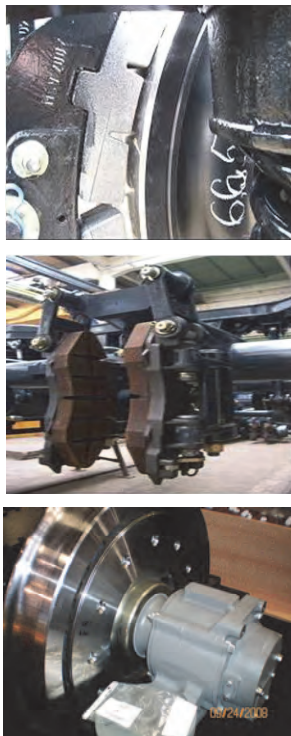
Foto 8. Osii (roți) prevăzute cu frână disc, saboți din materiale compozite.
