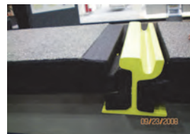
Foto 19. Modalități de prindere înglobată a șinei în elemente de amortizare.
