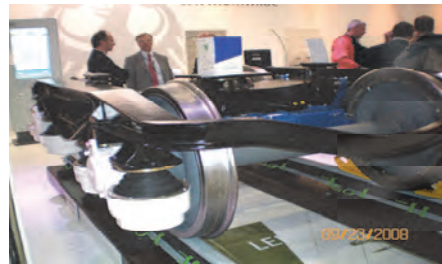
Foto 13. Boghiu vagon de marfa cu suspensie primară din elemente de cauciuc.
