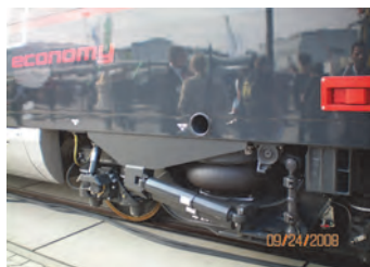
Foto 10. Sistem de rulare cu 2 etaje de suspensie.
