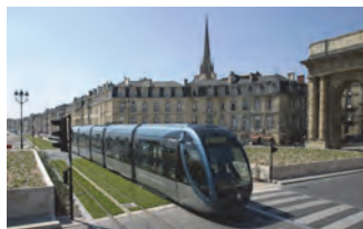
Fig. 4. Tramvai fără alimentare prin cabluri suspendate, fără stâlpi de susținere ai firelor, într-un peisaj urban valoros, în Bordeaux (Franța).
