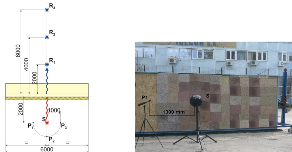
Fig. 3. Schema poziționării sonometrului B&K 2250 pentru înregistrarea zgomotului emis de sursă.
