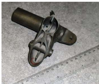
Secțiune printr-un nod. Sunt încercuite defectele.
