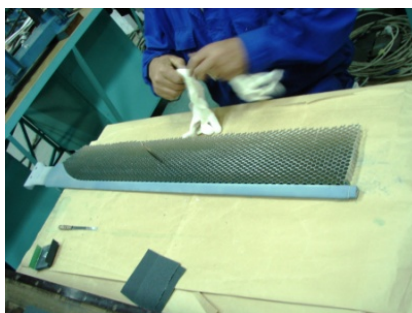
Lonjeron și nida de pală spate, lipite prin metoda metal-metal, la care se verifică distanța de lipire.
