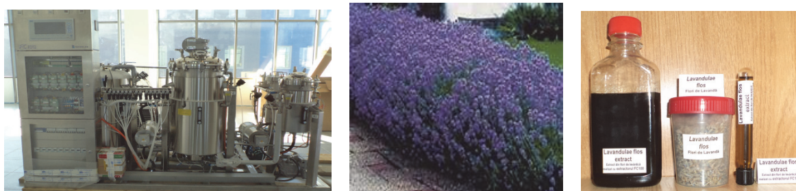
Fig. 2. Extractor cu gaz lichefiat la presiune subcritică, planta de extracție și extractul compușilor bioactivi.
