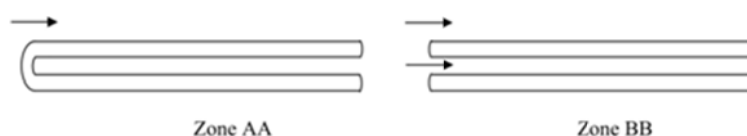
Fig. 2. Principiul de realizare A UNEI structuri tubulare bifurcate pe mașina specială NF 42 (Jacob Mueller-Frick, Elveția).
