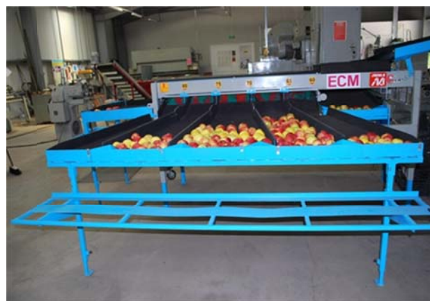
Fig. 6. Echipament pentru sortarea merelor după dimensiuni. Vedere laterală.
