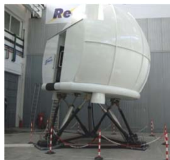
Fig. 8. Simulatoare de zbor realizate la S.C. Simultec S.A. – București cu componentele din materiale compozite de la S.C. Compozite S.R.L. Brașov.
