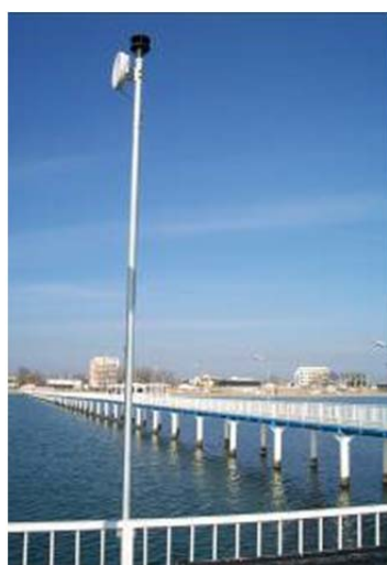
Foto 4. Poziționarea senzorului de vânt și a antenei.
