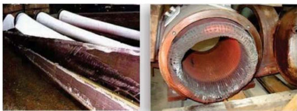
Fig. 1. Avarii produse în elementele componente ale turbinei eoliene ca urmare a solicitărilor mecanice și dinamice.
