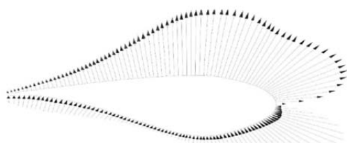
Fig. 4. Încărcarea aerodinamică – vedere transversală.
