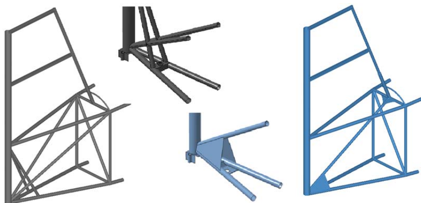
Fig. 12. Fuselaj spate și deriva cu detaliul zonei de montaj a bechiei (stânga – existentă, dreapta – reproiectată).
