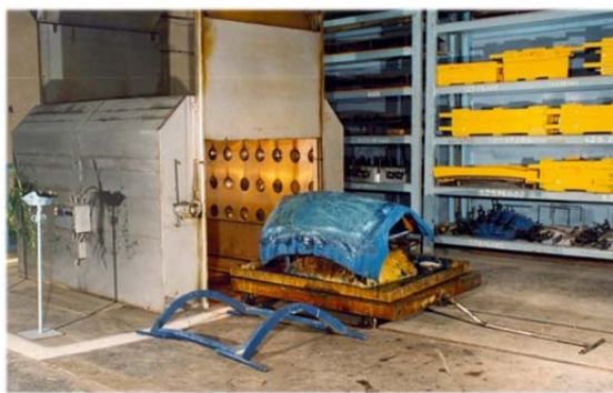
Cuptor încălzire și pregătire dispozitiv de formare geam prin tragere.
