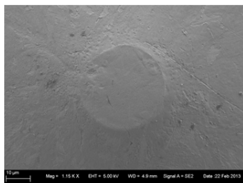
Fig. 4. Vedere generală a suprafeței plane la vârful asperității în cazul ruperii picăturii.
