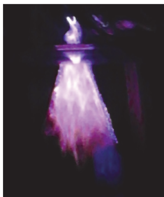
Fig. 1. GlidArc – succesiune de descărcări electrice alungite datorită suflării unui gaz între electrozi
