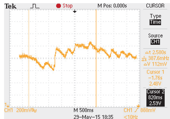
Fig. 8. Oscilații măsurate la pornirea unui sistem mecanic cu implementarea unei forme de variație sinusoidală a accelerației.
