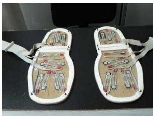
Fig. 10. Suportul cu senzori utilizați în analiza mersului
