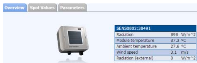
Fig. 10. Parametrii de intrare ai sistemului PV măsurăți de senzori.
