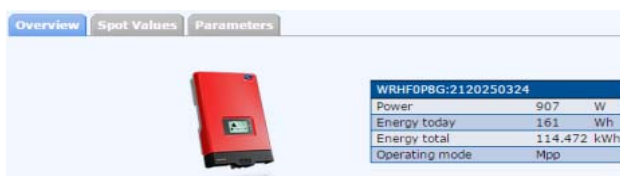
Fig. 11. Parametrii de ieșire ai invertorului de rețea.
