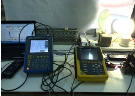
Fig. 27. Montaj lampa cu vapori metalici de înaltă presiune.
