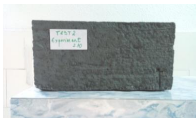
Fig. 3. Produs final cărămidă cod proba 2.10.
