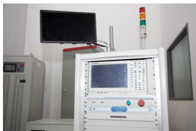
Instalația de testare a ansamblului de putere format din elici + motoare + reglere.
