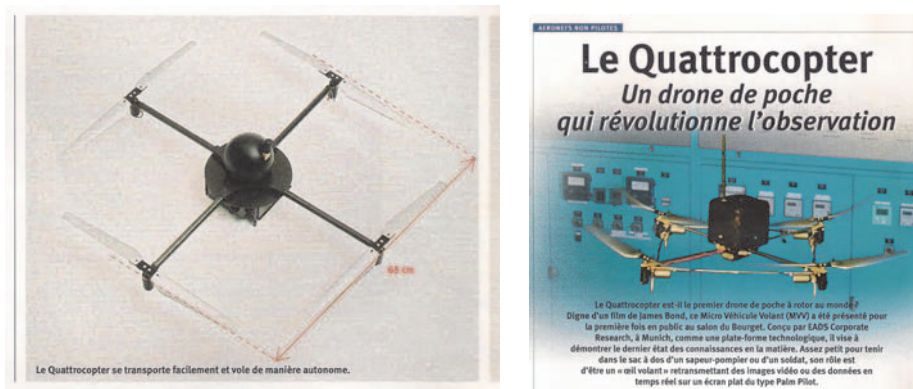
Fig. 4. Quattrocopter MVV cu patru rotoare fiecare cu diametrul de 65 cm realizat în Germania la München în perioada 1999-2003 de Corporate Research Center (CRC) din cadrul Defence and Security System.
