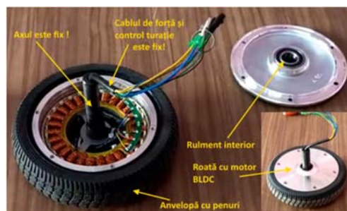
Figura 9. Roată cu motor de curent continuu fara perii, cu trei faze, tip BLDC comandat in impulsuri, integrat în interior, o noutate de ultimă oră în mecatronică.
