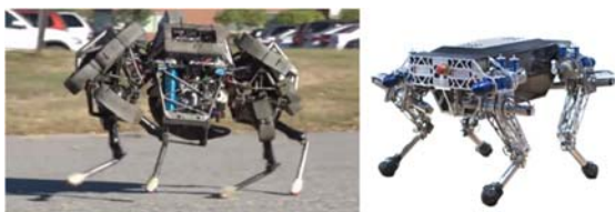
Figura 3. Roboții cu picioare articulate sunt încă în faza de cercetare (de la stânga la dreapta, WildCat – Boston Dynamics și StarETH – Institutul de robotică și sisteme inteligente din Zurich).
