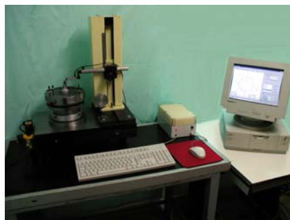
Fig. 10. Instalație de măsurat abaterile de formă ale pieselor circulare care folosește și transformata Fourier pentru prelucrarea datelor.
