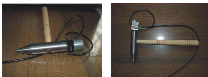
Fig. 7. Ciocănelul cu accelerometrul atașat pentru încercarea impulsivă
