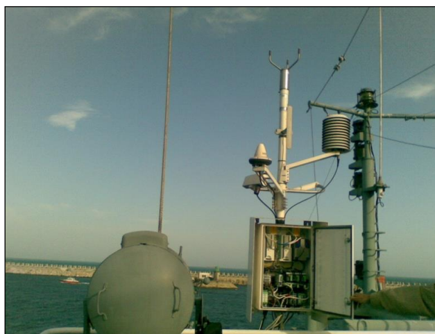
Fig. 2. Stație meteorologică automată navală MAWS 420 cu senzor WS425 instalată pe Nava Maritimă Hidrografică "Al. Cătuneanu" [7].
