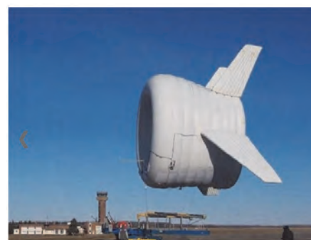
Fig. 4.5. Turbina eoliană zburătoare [12].
