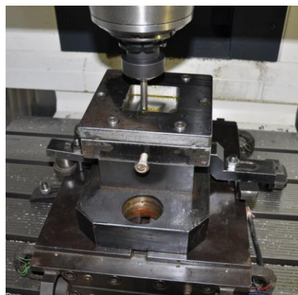
Fig. 3.1. Matrița montată pe masa mașinii de frezat.
