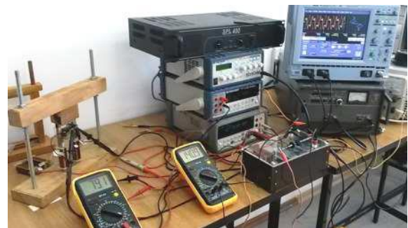
Fig.1. Echipamentul de măsură și achiziție cu integratorul RC și bobinele de măsură B , H [1].
