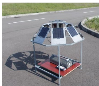
Fig. 3.1. Vedere a sistemului fotovoltaic orientat 180° după lumina solară.
