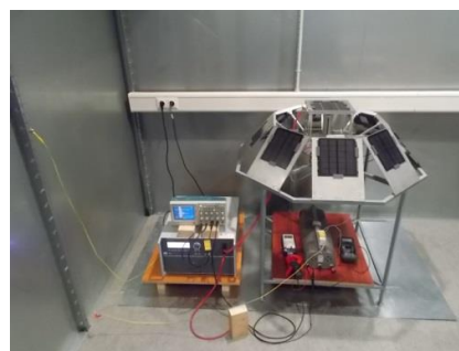
Fig. 3.2. Vedere a sistemului fotovoltaic testat la lovituri indirecte de trăsnet.
